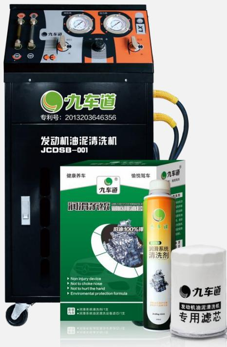
九车道独家专利技术，区别于市场常规机器，采取多次动态抽吸，并通过特制8微米滤芯循环过滤，通过加压吹除，有效清洗活塞环槽沉积物，保持发动机动力充沛，循环过滤，外循环，能彻底清除机体内的积碳。100%排出机体内的旧机油，防止旧机油残留污染新机油，使新油使用更持久。具有预润滑效果，防止机体内部干磨损，避免内部损伤，延长发动机使用寿命。
